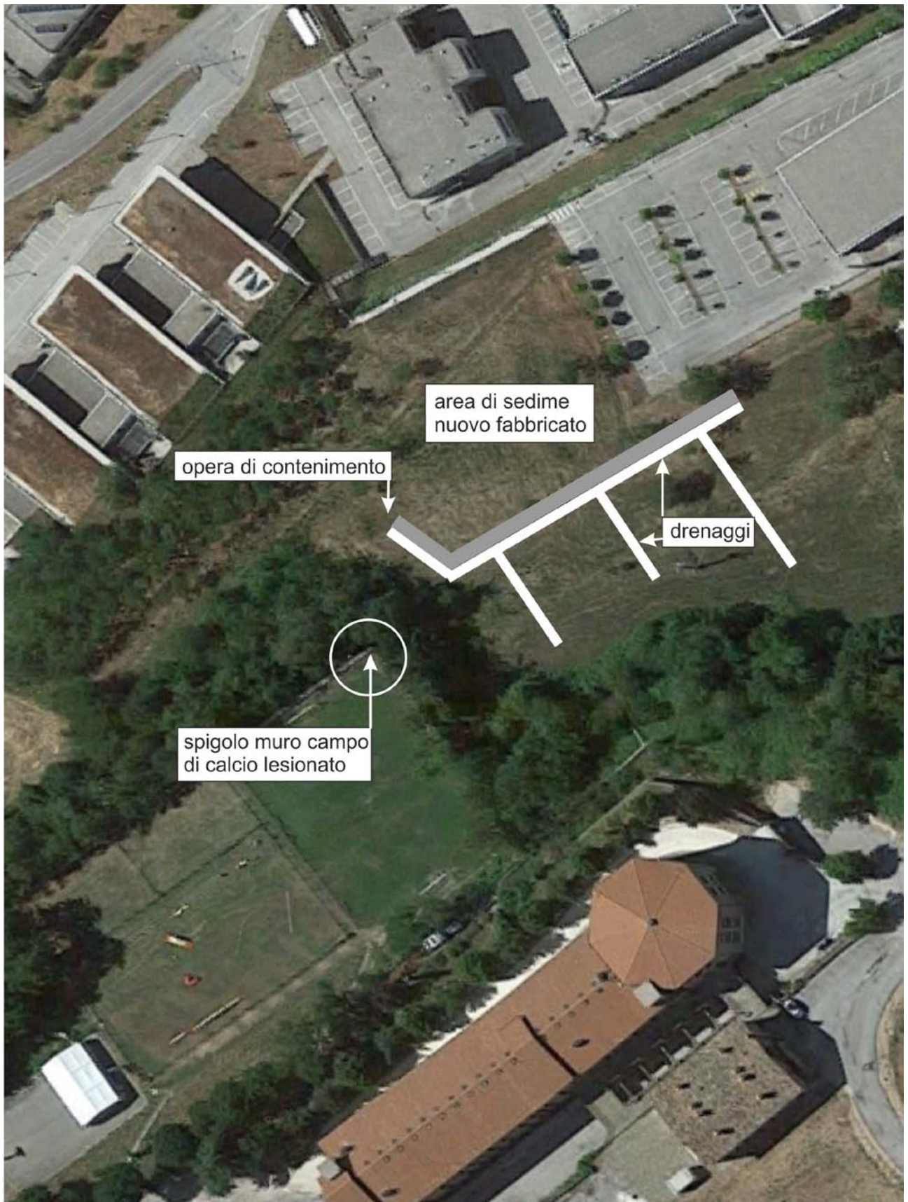
Pianta con interventi da realizzare
