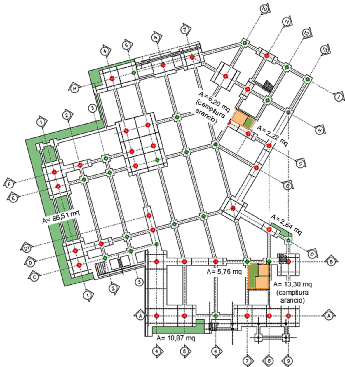
Figura 2.3 – Piano fondazione: area solette e marciapiedi con H=20 cm (cappitura color verde) e solette fosse ascensore con H=20 (cappitura color arancio)
